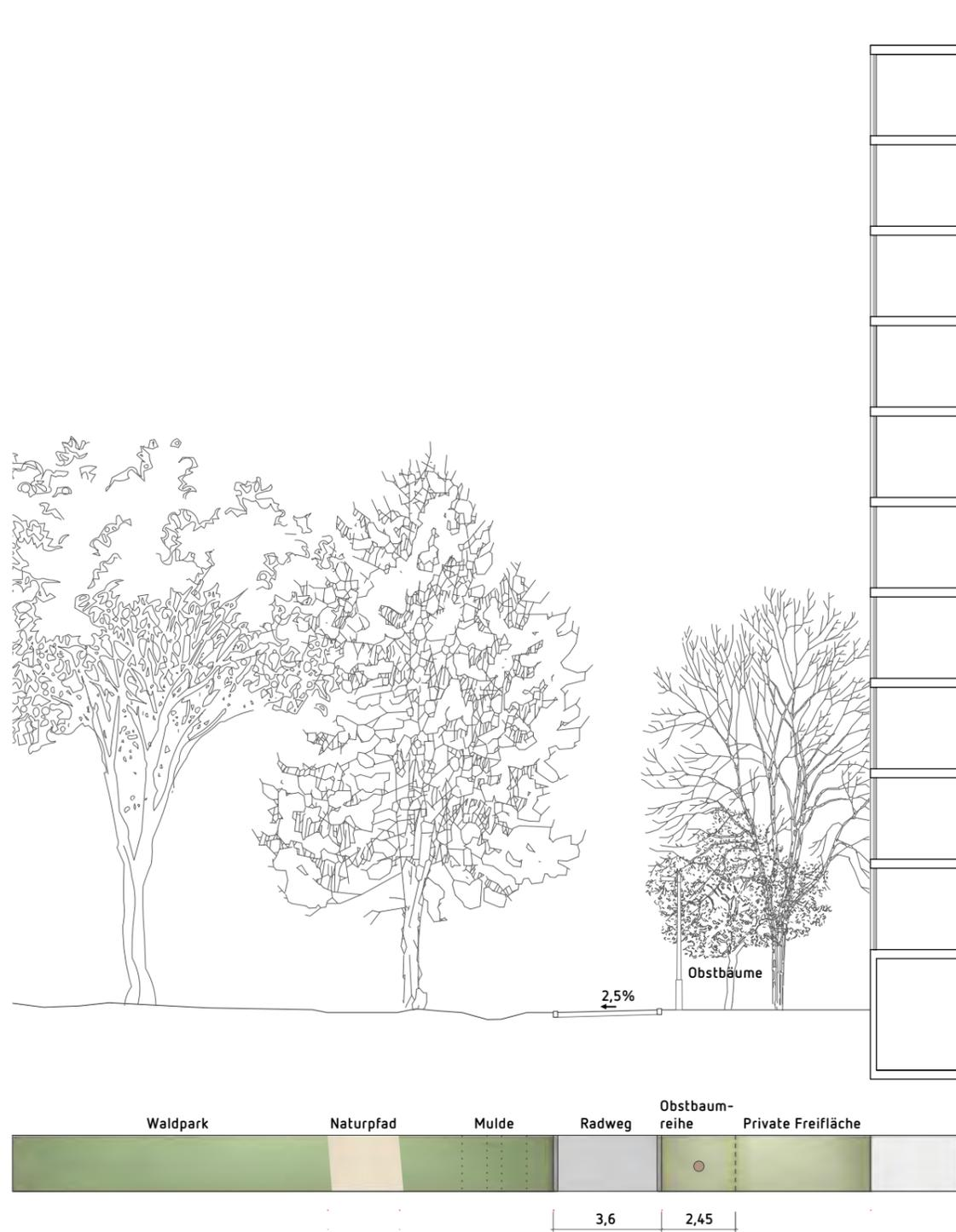
A-A Profilschnitt: Ost-West-Radverbindung – 1:200
